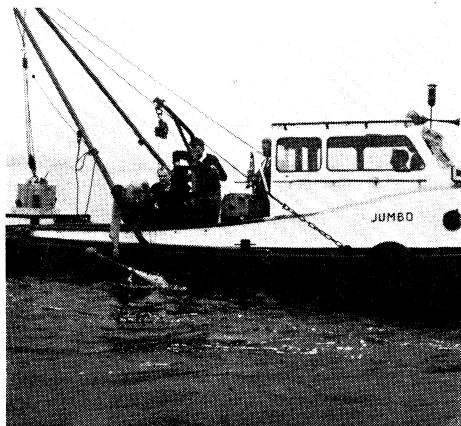
Een Ott-stroomsnelheidsmeter wordt over boord gezet
